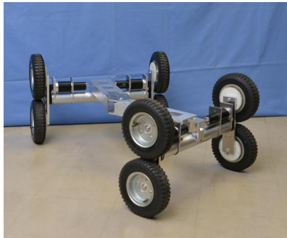
図6 組立てが完了した8輪ロボット
